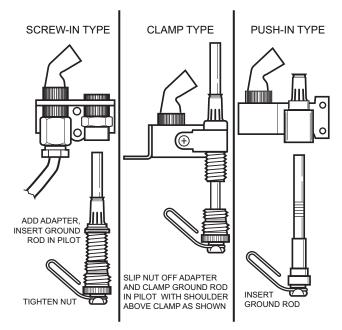
BE SURE THE GROUND CLIP IS SNAPPED ONTO THE PILOT BURNER OR ITS GAS LINE. M24902
